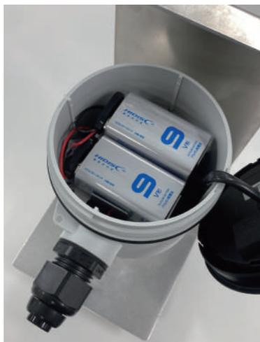
▲電池式を採用し、小型ながら精密な測定性能を発揮。簡単に持ち運べ、コンセントいらずで使用いただけます。
